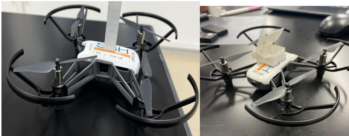
短冊形の梱包を載せたドローン（左） / 箱型の梱包を載せたドローン（右）
